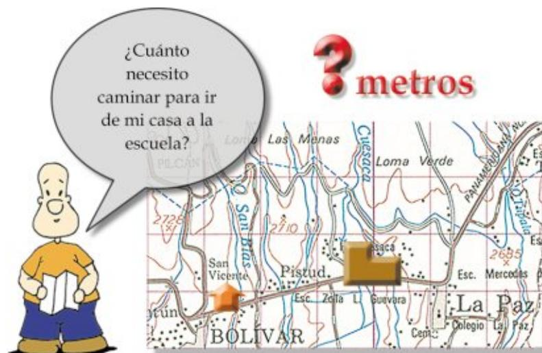
Realizando una sencilla operación podremos calcular cualquier distancia medida sobre el plano y transformarla en la distancia real existente en el terreno.
