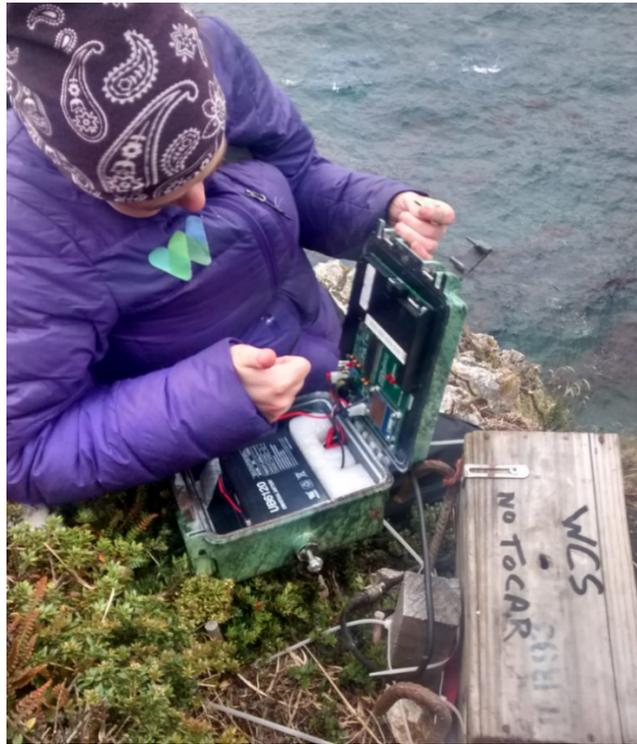
**Figura 7.** Reinstalación de cámara BuckEye Cam® RC-5030 para monitoreo de actividad en la colonia. Islote Albatros, Seno Almirantazgo. Diciembre de 2018.
